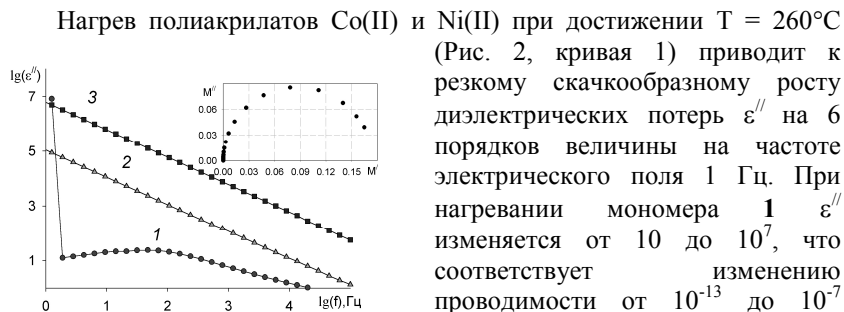
Рис. 2. Зависимости \epsilon''(f) для мономера 1 при нагреве до 260°C (1) и после процесса декарбокислирования T=140°C (2) и T=260°C (3). Вставка - диаграмма модуль-модуль для T=140°C (2).
