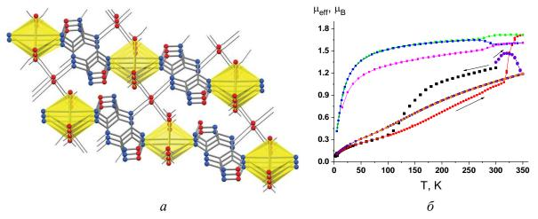
**Рисунок 1.** Фрагмент структуры NaL\*( $H_2O$ )<sub>3</sub> (a); температурные зависимости эффективного магнитного момента  $\mu_{\rm эфф}$  для  $Cs(L^*)(H_2O)_2$  ( $\delta$ )
