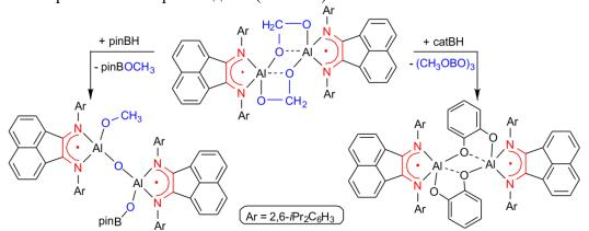
Схема 1. Гидроборирование диоксида углерода, связанного гидридом алюминия
