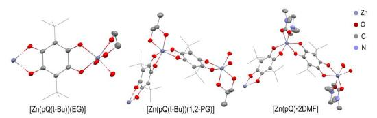
**Рисунок 1.** Звенья МОКП [Zn(pQ(t-Bu))(EG)], [Zn(pQ(t-Bu))(1,2-PG)] и [ $Zn(pQ(t-Bu))\cdot 2DMF$ ]
