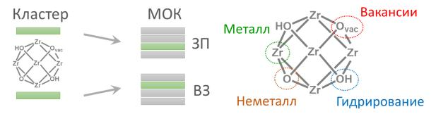
Рисунок 1. Схема подбора компонентов кластера для изменения электронных свойств МОК [1]
