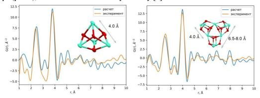
**Рисунок 1.** Сравнение расчетных и экспериментальных функций парного распределения G(r) для комплекса  $[Dy_4(OH)_4(tfa)_2(deta)_4(detadcH)_2](tfa)_4 \cdot nH_2O$  (слева) и комплекса  $[Pr_9(OH)_{12}(tfa)_{11}(deta)_6(detadcH)_2](tfa)_2 \cdot (2+n)H_2O$  (справа).
