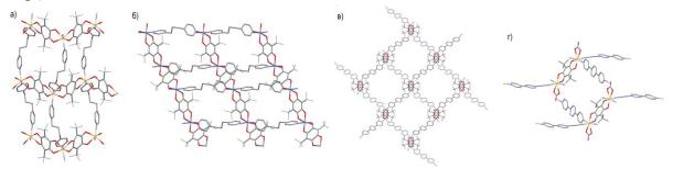
**Рисунок 1.** МОКП [Zn(pQ)(Pr-dipy)] (a), [Cd(pQ)(Pr-dipy)] (б), [Zn(pQ)(4py-tetraz)] (в), [Cd(pQ)(NO<sub>3</sub>)(4py-tetraz)<sub>1.5</sub>] (г). Где pQ — дианион 2,5-дигидрокси-3,6-ди-трет-бутил-парабензохинона, Pr-dipy - 4,4'-триметилен-дипиридин, 4py-tetraz - ди-3,6-(4-пиридил)- 1,2,4,5-тетразин
