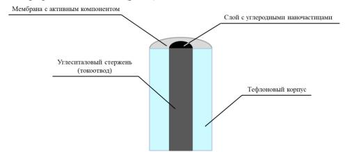
Рисунок 1. Строение твердоконтактного электрода
