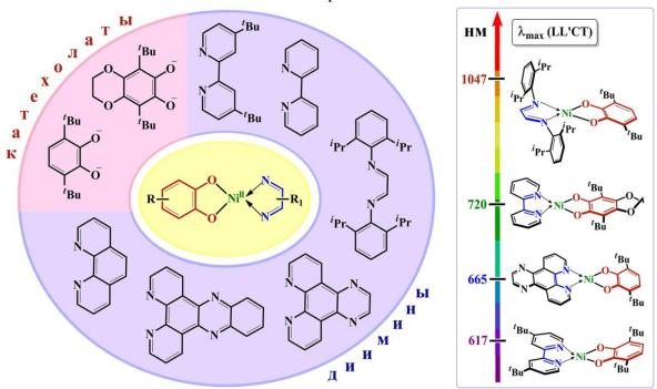
**Рисунок 1.** Хромофоры «диимин-Ni<sup>II</sup>-катехолат» (слева); смещение LL'CT полосы (в растворе  $T\Gamma\Phi$ ) для некоторых металлокомплексов (справа).
