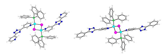
**Рисунок 1.** Молекулярная структура комплексов Cu(I) полученных в работе
