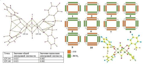
**Рисунок 1.** Изомерия лигандного окружения кластеров  $Pd_4(CO)_4(RCO_2)_4$  (справа), пример результатов расчета в теории «AIM»
