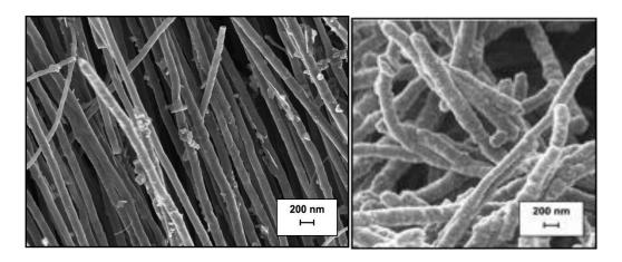
**Рисунок 1.** РЭМ микрофотография исходных МУНТ (слева). РЭМ микрофотография композита TiC/MУНТ (справа).
