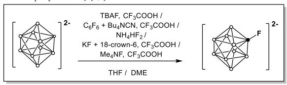
**Рис. 1.** Условия реакций фторирования аниона  $[B_{10}H_{10}]^{2-}$ .
