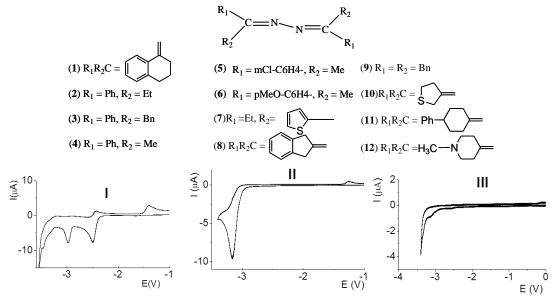
**Рисунок 1.** Характерные вольтамперограммы представителей I-III групп азинов в 0.1 М ТВАР $F_6$  / ДМФА (относительно Ag/Ag<sup>+</sup>), v = 100 мВ/с
