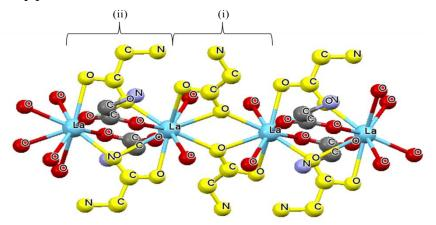
**Рисунок 1.** Структура [La(Gly)<sub>3</sub>·2H<sub>2</sub>O](ClO<sub>4</sub>)<sub>3</sub> (i) двойной бидентатный мост, ( $\mu_2$ - $\eta^2\eta^1$ )<sub>2</sub>, (ii) четверной хелатный мост, ( $\mu_2$ - $\eta^2\eta^1$ )<sub>2</sub> + ( $\mu_2$ - $\eta^1\eta^1$ )<sub>2</sub>
