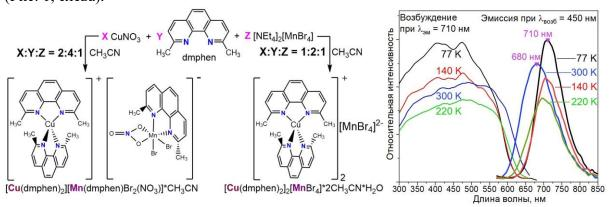
**Рисунок 1.** Слева: схема синтеза гетерометаллических комплексов Cu(I)-Mn(II); **справа:** температурная зависимость фотолюминесцентных свойств комплекса  $[Cu(dmphen)_2][MnBr_4]*2CH_3CN*H_2O.$
