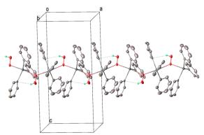
**Рисунок.** Фрагмент 1D координационного полимера в структуре Ph<sub>3</sub>PbOOH.
