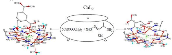
**Рисунок.** Схема синтеза полиядерных гетерометаллических комплексов  $Ca(C_8H_4O_4)(H_2O)[15-MC_{Cu(II)Glyha}-5](H_2O)_{16}$  and  $Ca(C_4H_2O_4)(H_2O)[15-MC_{Cu(II)Glyha}-5](H_2O)_{15}$
