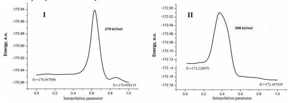
**Рисунок 1.** МЕР стадии **I**:  $H_2 + HCONH_2 \rightarrow HOCH_2NH_2$  и **II**:  $H_2 + HOCH_2NH_2 \rightarrow H_2O + CH_3NH_2$ .
