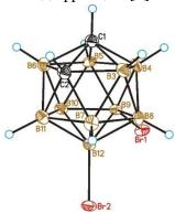
**Рисунок 1.** Общий вид 9,12-Br<sub>2</sub>-*орто*- $C_2B_{10}H_{10}$  с нумерацией атомов. Тепловые эллипсоиды рисуются с вероятностью 50%.
